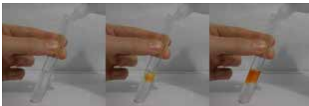
Abb. 3 - Beobachtung: Bei Zutropfen der Wasserstoffperoxid-Lösung entsteht eine gelborange Färbung.
